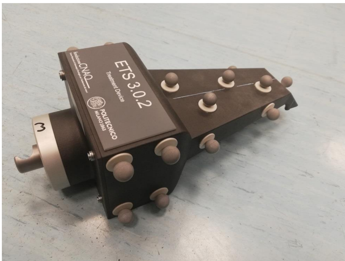
Figura 18 - La nuova versione del dispositivo di tracking ottico ETS 3.0.
