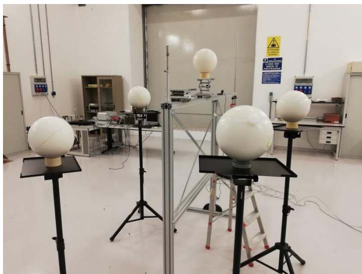
Figura 3 - Alcuni strumenti per neutroni del CNAO, durante il lavoro di taratura alla facility di metrologia neutronica del PoliMi (Dicembre 2019).
