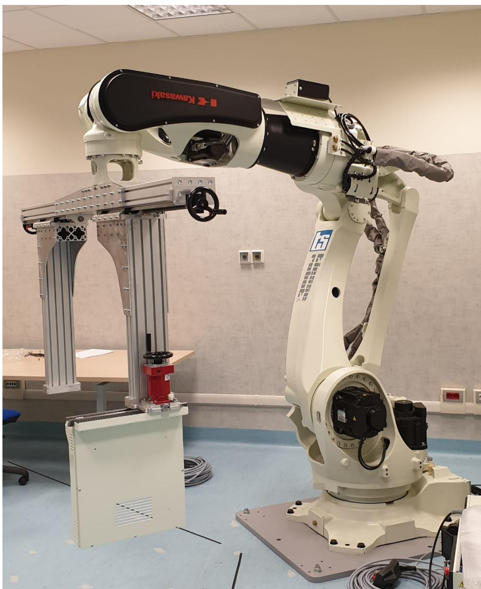
Figura 20 - Il dispositivo robotico e la struttura ad "U" installati nella sala di sviluppo.
